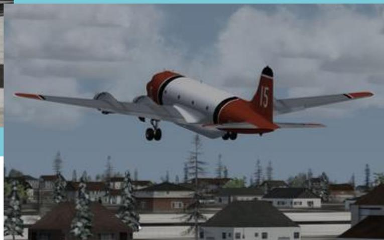
Nous arrivons à 4000ft, le niveau de croisière. Nous affichons 33"/2000t/min. L'avion va accélérer doucement vers 170kt. Nous en profitons pour régler finement la richesse et les volets. La tenue d'altitude est engagée au pilote automatique ainsi que le mode cap.
