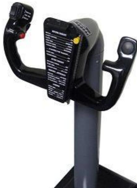
Celui de gauche a les boutons du trim à gauche sur le yoke, celui du sous-officier les boutons du trim à droite.
